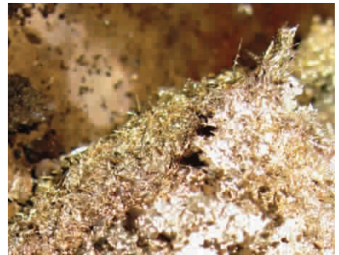
图 4 锡-铜-镍-锆无铅焊料 HASL 焊料槽底部挖出的锡铜金属间化合物
